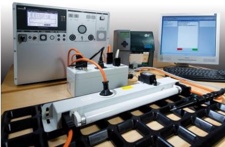
Jede Schaltschrankleuchte wird nach einem genau definierten Prüfplan auf Sicherheit und Funktion getestet bevor sie zur Auslieferung bereit gestellt wird.
